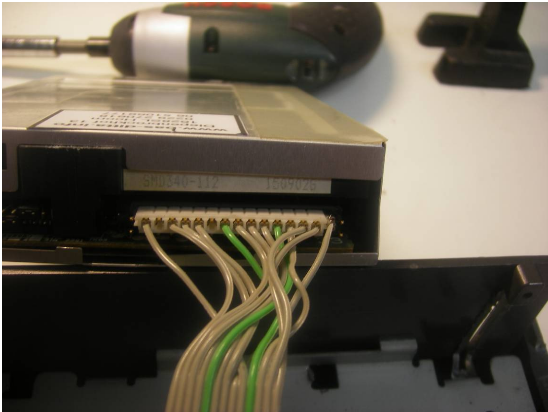
Op deze manier wordt de kabel aangesloten op de diskdrive zonder verloopprint
